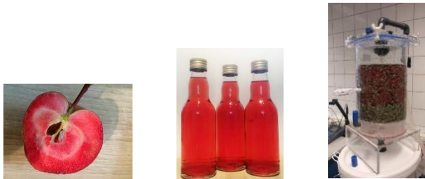
Abb. 2: Königsapfel: Frucht, Saft, Festbettreaktor mit Apfeltrester gefüllt
